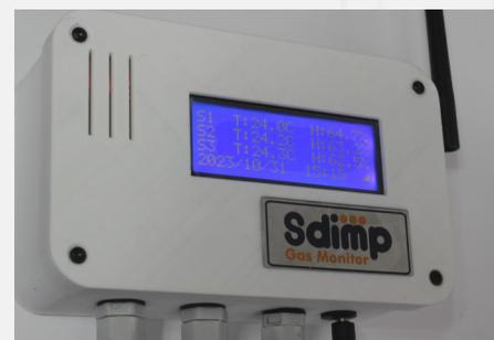
Sistema de conexión wi-fi para la transmisión de datos y visualización remota de las mediciones de humedad y temperatura con acceso desde cualquier dispositivo por medio de una interfaz digital.
